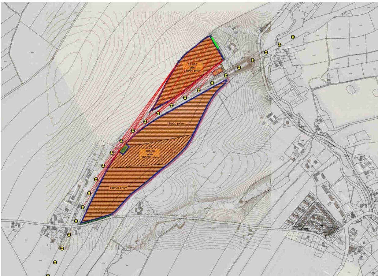
Bei der vorliegenden Geometrie wurden in Richtung der entfernten Beobachter lediglich Streiflichtreflexionen in den Tagen um die Sommersonnenwende herum ermittelt, die vom Kurvenbereich der Bahnstrecke aus an den südlichsten Moduloberflächen gesehen werden können. Unter Streiflichtreflexionen sind Sonnenlichtreflexionen zu verstehen, bei denen der
