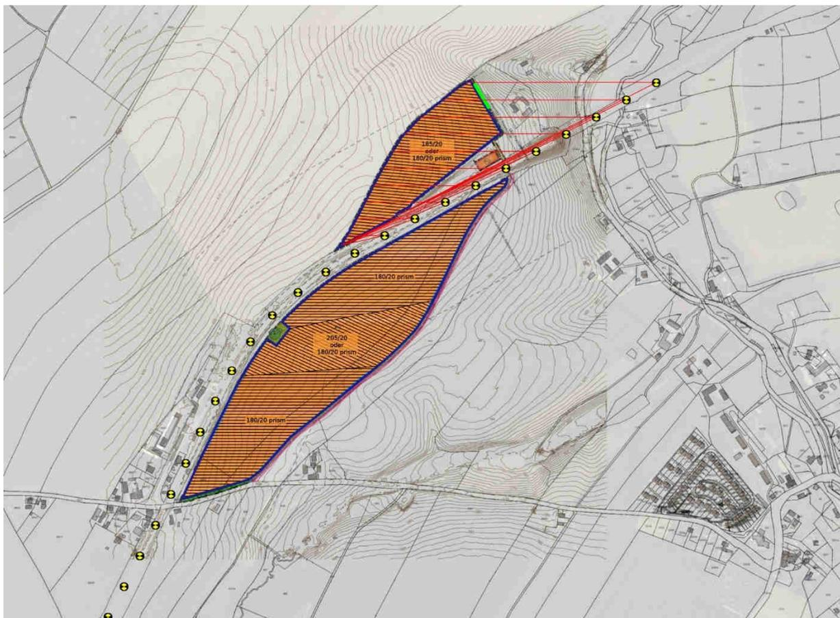
Durch das nach Osten hin abfallende Gelände und die dadurch verursachte Querneigung werden hier teilweise sehr flache Einblickwinkel auf die Moduloberflächen möglich, bei denen in Richtung der vermerkten Beobachter am äußeren rechten Sichtfeldrand Reflexionen bei tief stehender Sonne auftreten können.
