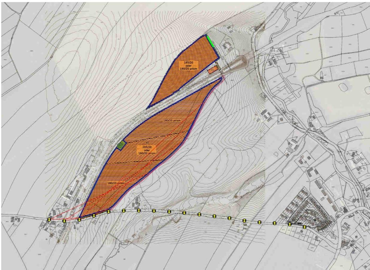
Hier wurden bei Einsatz der vorgesehenen PV-Module mit prismatisch verformtem Frontglas Saint Gobain Albarino P oder gleich wirkend keine relevanten Blendwirkungen oberhalb der anzusetzenden Schwelle von 100.000 cd/m<sup>2</sup> ermittelt.
