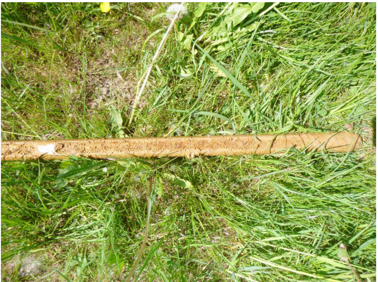
Bild 6: Bohrung 3, Mittelsand, grobsandig, schluffig, tieferer Bereich bei 3,5-4,1 m.
