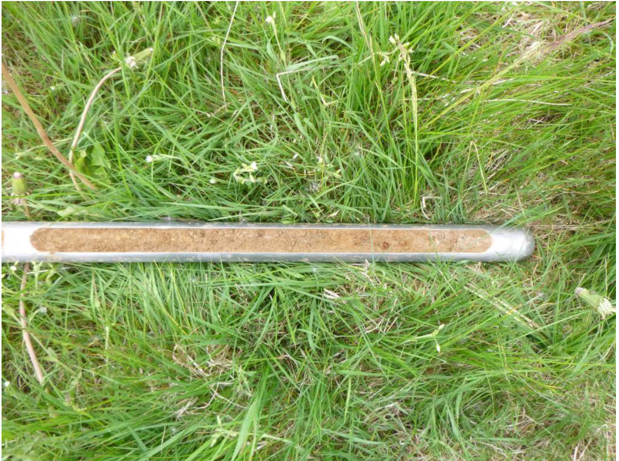
Bild 5: Bohrung 7, Mittelsand, stark feinsandig, schwach schluffig, Bereich bei 2,5-2,9 m.
