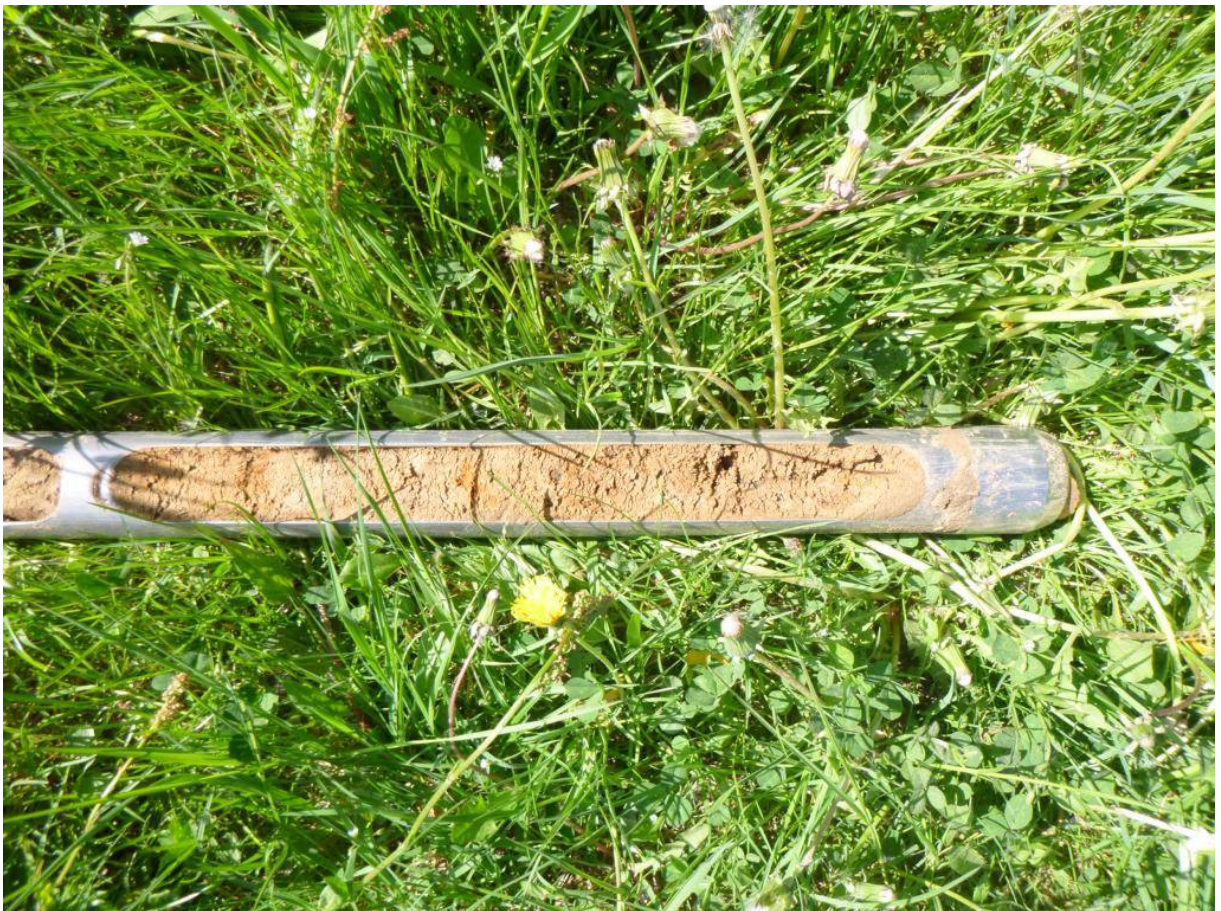
Bild 4: Bohrung 1, Schluff, feinsandig, schwach kiesig, Bereich bei 0,5-1,0 m.
