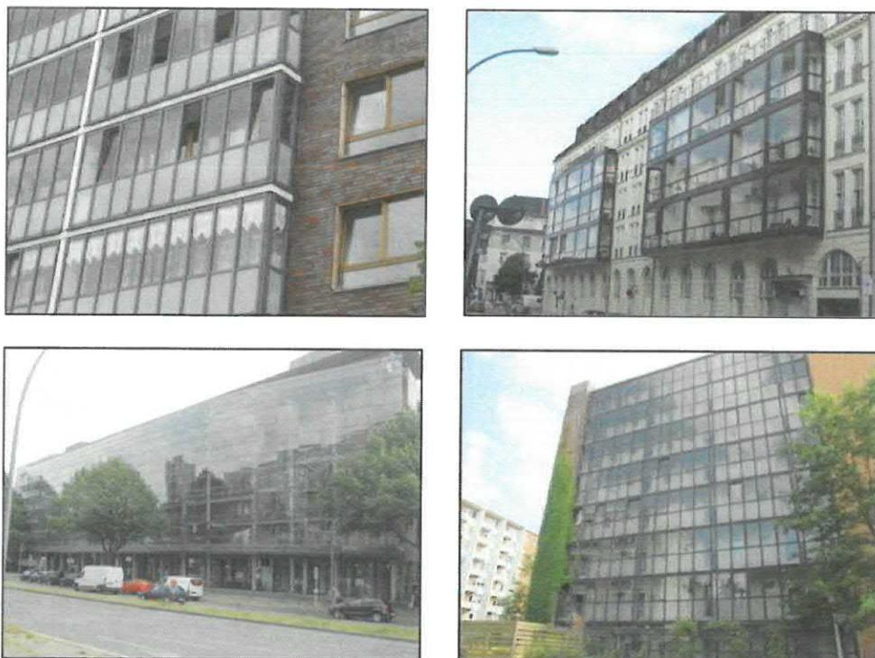
Abbildung 1: Beispiele für teilgeöffnete Außenbauteile zum Schutz gegenüber Verkehrslärm (oben: geschlossene Vorbauten, unten links: Vorhangfassade, unten rechts: Laubengänge)
